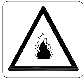
RIESGO DE INCENDIO
