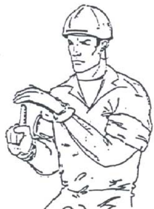
3.-LEVANTAR LA CARGA LENTAMENTE
