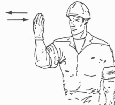
12.- GIRAR EN LA DIRECCION INDICADA POR EL SEÑALISTA
